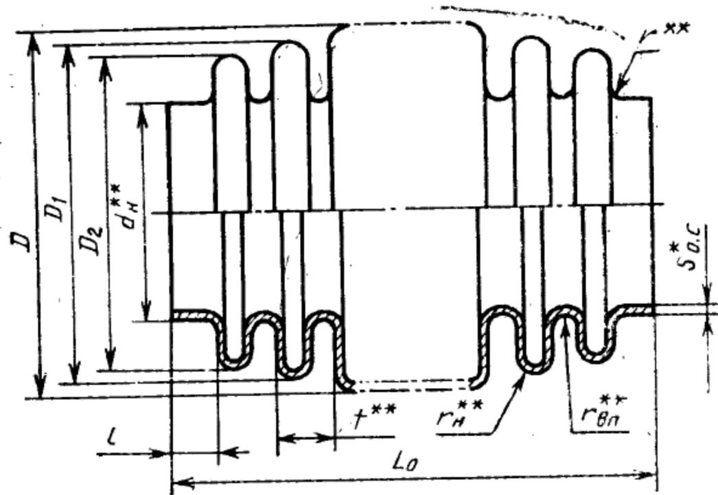
$D_1$ —наружный диаметр второго гофра;  $D_2$ —наружный диаметр первого гофра
